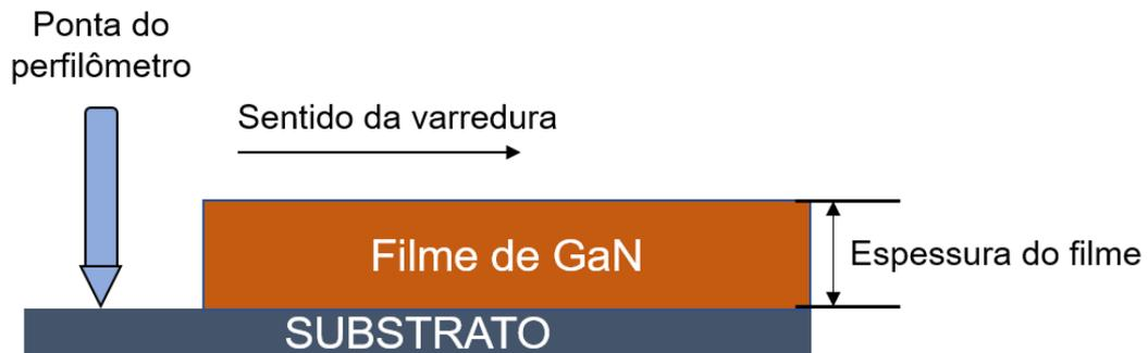
Figura 27: Esquema representativo da medida de degrau de um filme fino pela técnica de perfilometria mecânica.
